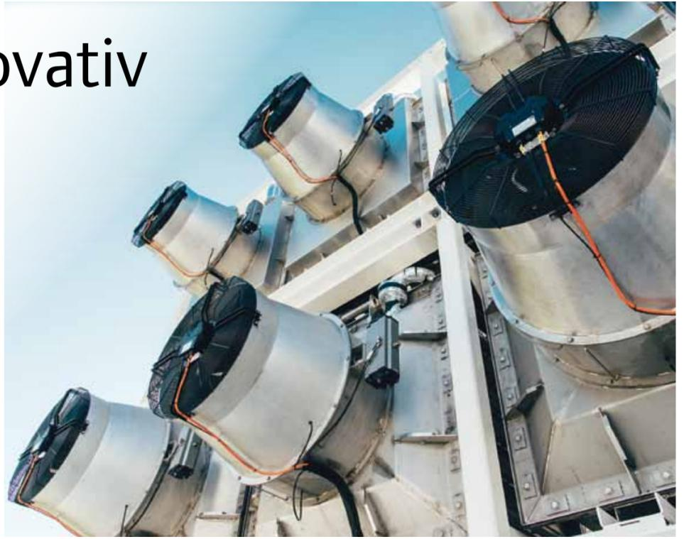
Die kommerzielle Filteranlage von Climeworks in Hinwil saugt pro Jahr ungefähr 600 Tonnen CO<sub>2</sub> aus der Luft. (Foto von Julia Dunlop)
